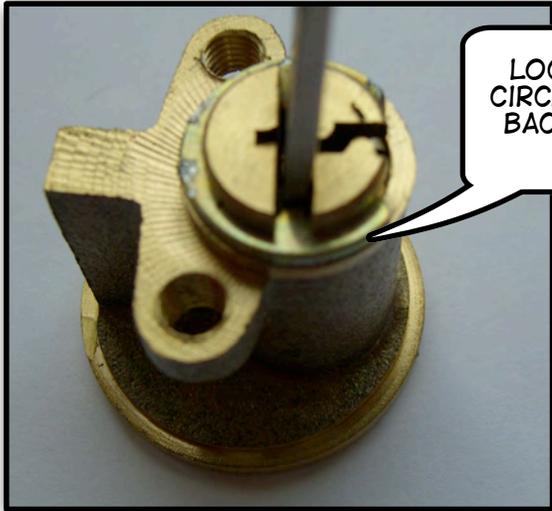
LOCATE THE CIRCLIP AT THE BACK OF THE PLUG
